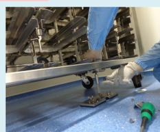
②本体に取り付け、床に水平になるように向きを調整する
